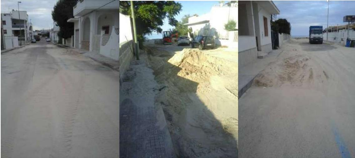
**Figura 30: Esempi di vie stradali che terminano sulla spiaggia. Da questi “varchi”, per azione del vento, si determina una notevole dispersione di sabbia nel retro spiaggia urbanizzato**
