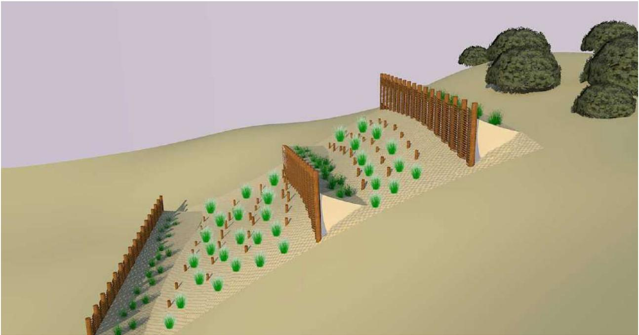
**Figura 31: Esempio di sistema di protezione della duna con graticciate e messa a dimora di specie erbacee**
